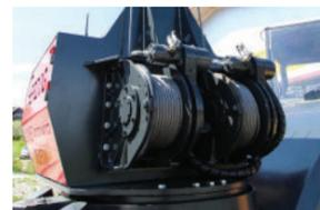
Die MW500R *Synchrowinch* ist mit zwei Ankerwinden ausgestattet. Diese Winden können dynamisch geregelt werden (ähnlich der Hauptwinde) um das ferngesteuerte Fahren mit gleichzeitiger Stabilisierung zu ermöglichen.
