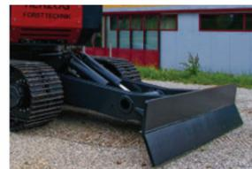
Die massive Bergstütze stabilisiert die Maschine und dient als Ankerung. Wenn das Seil längs zur Windenmaschine gezogen wird, kann ohne Abspannung gearbeitet werden.
