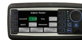
Steuereinheit der MW500R. Auf den beiden Displays sind alle wichtigen Infos für den Betrieb und Fehlerdiagnose der Winde zusammengefasst.
