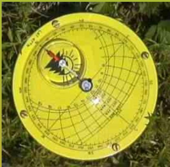
Der Sonnenkompass besteht aus einer gelb eloxierten Aluminiumscheibe von 116 mm Durchmesser mit einer schwarz aufgedruckten Skala. In der Mitte befindet sich eine Wasserwaage und darunter ein kleiner Präzisionskompass, die es erlauben, das Instrument genau nach Norden und im Lot auszurichten. Bedeckt ist das ganze mit einer Plexiglaskuppel von etwa 25 mm Höhe. Der Sonnenkompass wiegt nur 98 Gramm.
