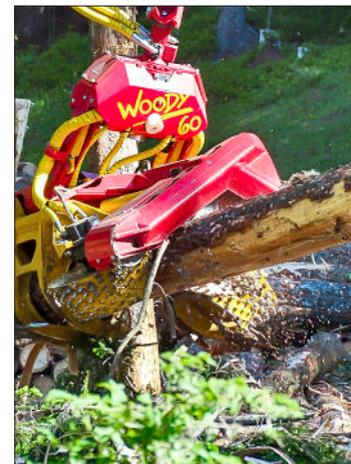
**Der Woody60 schneidet, schält und greift Stämme bis zu einem Durchmesser von 60 Zentimetern.**
