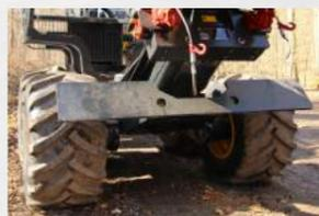
Als Option kann eine Bergstütze angebaut werden, welche als Ankerung und für das Abziehen von Wegen verwendet werden kann.
