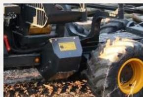
Es können wahlweise eine oder sogar zwei Winden an der Maschine installiert werden. Eine Winde kann optional als Traktionshilfwinde ausgerüstet werden.
