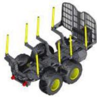
Bei heruntergeklapptem Hochhub und geöffneter Klemmrunde behält die Maschine ihre uneingeschränkte Kurzholz Ladefähigkeit.
