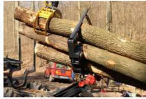
Als Zubehör für Langholz ist eine dreh- und kippbare Klemmrunde verfügbar, welche aufgeklappt als letzte Runge dient. Auf Wunsch ist das System auch mit einer Schnellwechsel-Klemmbank kombinierbar.
