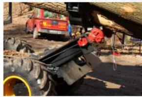
Auf Wunsch können beide Winden mit hydraulischem Seilausstoss ausgerüstet werden, was für eine optimierte Wicklung sorgt. Optional ist ein Heckhochhub, welcher die Seilausläufe auf 1,85m Höhe anhebt.
