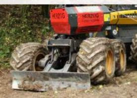
Die massive Bergstütze stabilisiert die Maschine und dient als Ankerung. Wenn das Seil längs zur Windmaschine gezogen wird, kann ohne Ankerseile gearbeitet werden.
