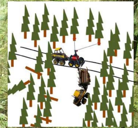
1. Die Hangmaschine fährt mit Seilunterstützung bis an die Wegkante.
