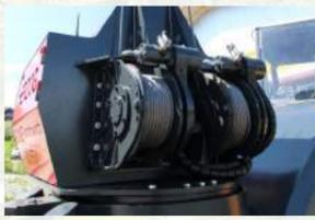
Die MW500 Synchronwinch ist mit zwei Ankerwinden ausgestattet. Diese Winden können dynamisch geregelt werden (ähnlich der Hauptwinde) um das ferngesteuerte Fahren mit gleichzeitiger Stabilisierung zu ermöglichen.
