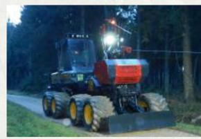
Als Trägerfahrzeuge dienen gebrauchte Ponsse Harvester. Alle Harvester mit HN125, HN200, C2, C22, C33, C4 oder C44 Kran können verwendet werden.
