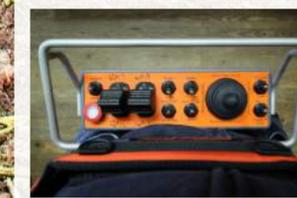
Alle Funktionen - inklusive Schild, Winde drehen und Fahrfunk - können mit der Funkfernsteuerung bedient werden. Der Fahrer muss seine Kabine nicht verlassen.
