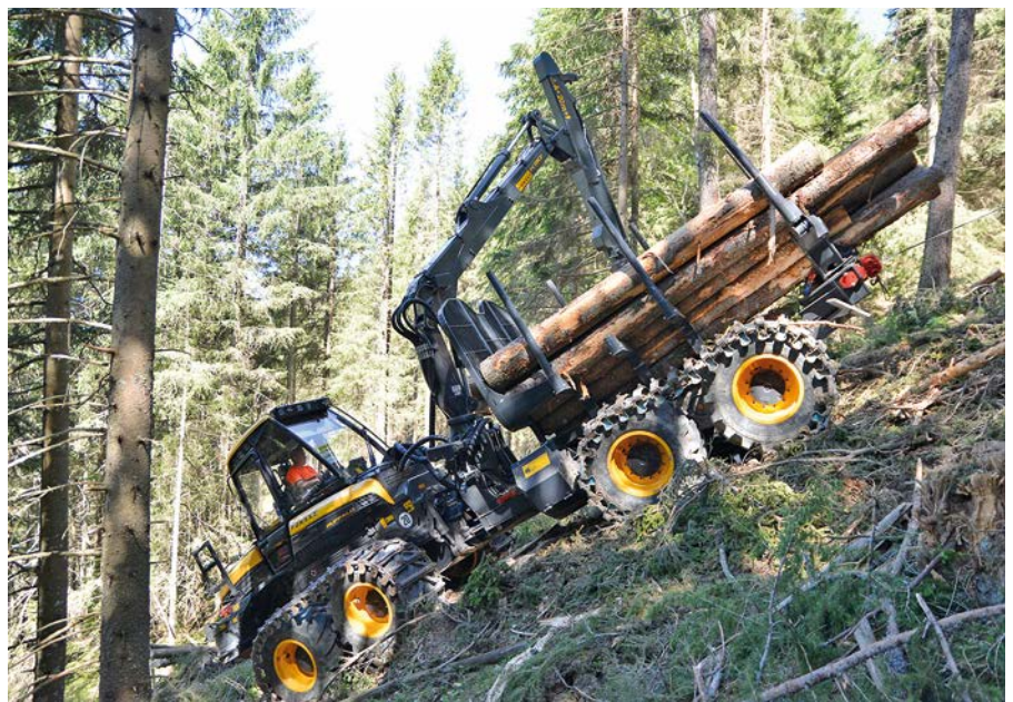
Oben: Harvester Ponsse Bear mit Herzog-MW-500-Traktionswinde. Rechts: Forwarder Ponsse Buffalo mit Herzog Synchronwinch.
