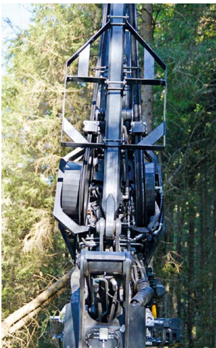
Oben: Herzog konstruierte für den Kran C55 einen neuartigen Langausleger mit innenliegender Schlauchführung mit 14 Meter Reichweite. Links: Seitlich am Kran ist die spezielle Schlauchwicklung zu sehen.
