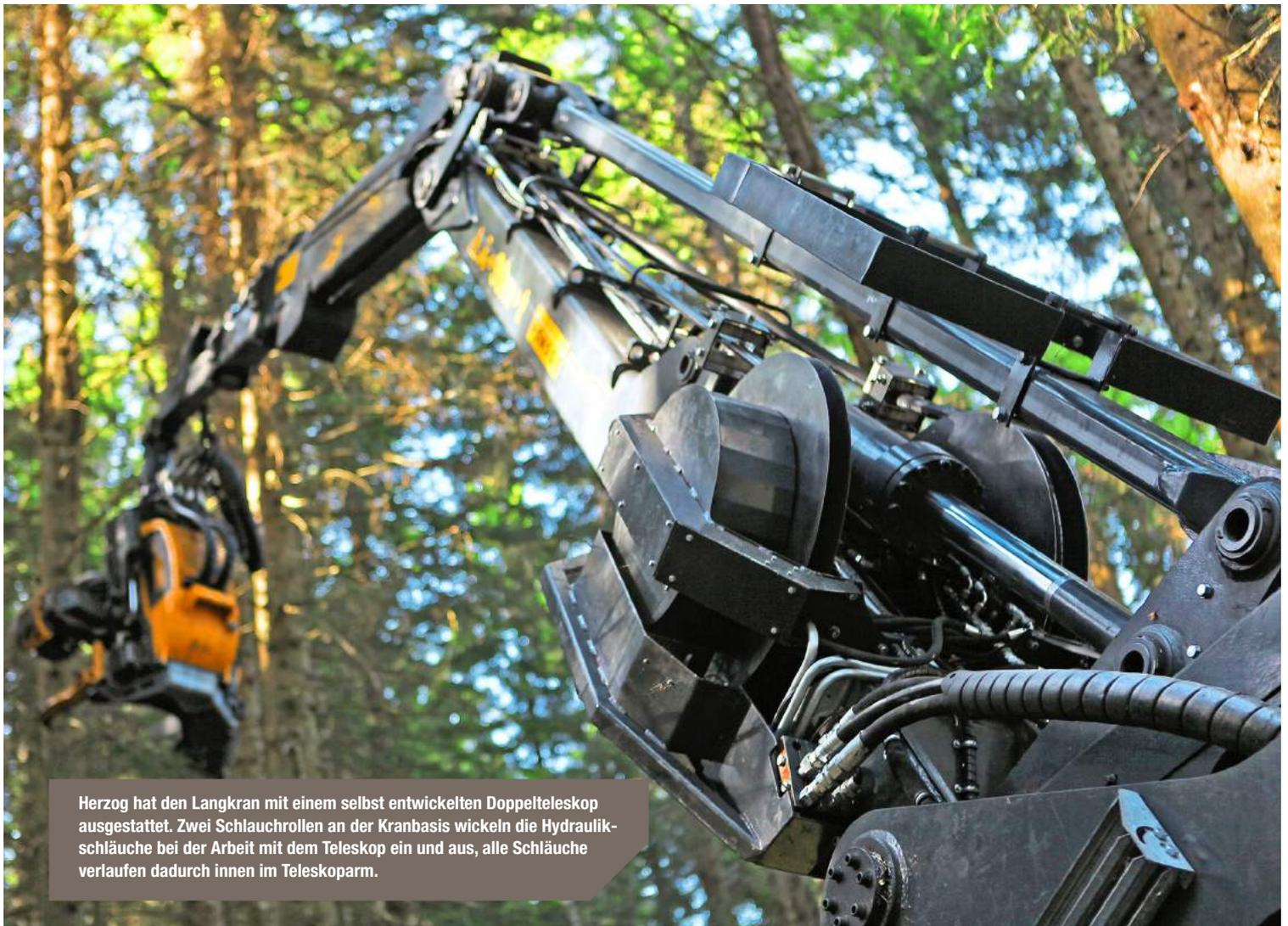
Herzog hat den Langkran mit einem selbst entwickelten Doppelteleskop ausgestattet. Zwei Schlauchrollen an der Kranbasis wickeln die Hydraulikschläuche bei der Arbeit mit dem Teleskop ein und aus, alle Schläuche verlaufen dadurch innen im Teleskoparm.
