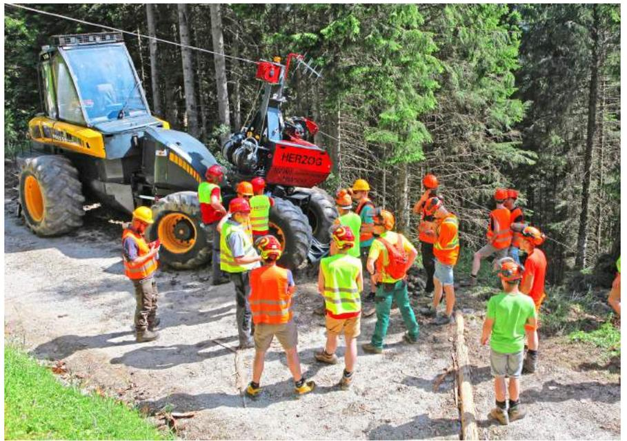
Eine Alternative zum Seilkrane ist je nach Gelände- und Hangneigung der Einsatz von Traktionswinden. Hier ist ein Ponsse Ergo Trägerfahrzeug für die externe Alpine Synchronwinch MW500. Ein Ponsse Bear arbeitet mit ihrer Unterstützung gerade unterhalb von ihr im Hang.
