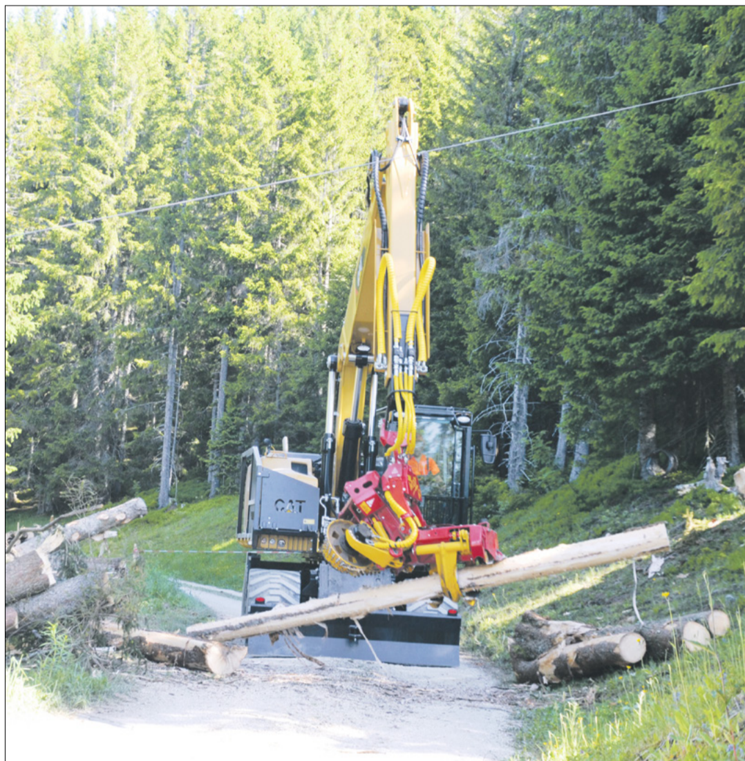
Mit dem Woody 60 ist das Entasten der Bäume keine Schwerstarbeit mehr. Der Woody am Kranende kann Bäume von einem Umfang von 60 cm packen und entasten.
